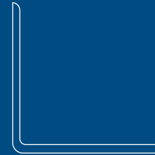
L-PROFIL min. 30×20 mm max. 160×100 mm oder 100×100 mm
